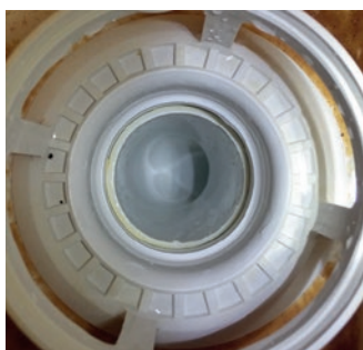
Entkalktes Spülrohr nach Service
