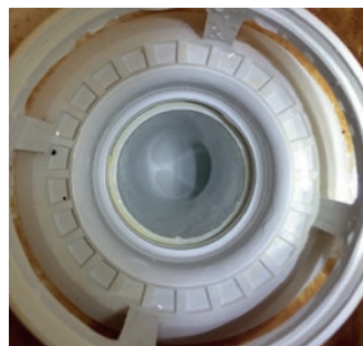
Entkalktes Spülrohr nach Service
